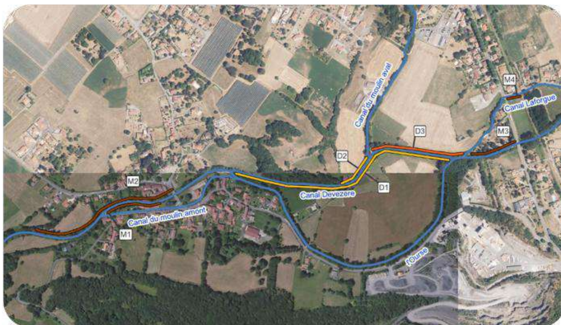
Figure 113 : Présentation du dispositif de protection de protection contre les inondations de l'Ourse
