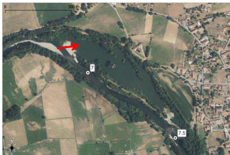
Figure 29 : Capture de la gravière de Taillebourg lors de la crue de de 2022
