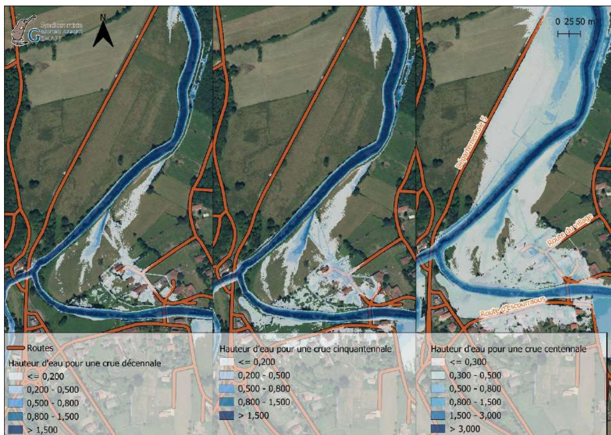
Figure 110 : Impacts des débordements du Ger sur les routes pour Q10, Q50 et Q100
