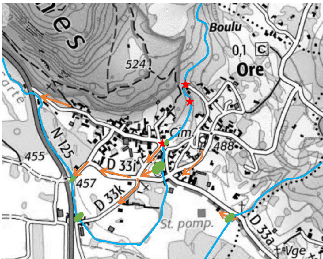
Figure 4: Localisation des zones en présence d'embâcles (étoile rouge), les zones de dépôts de matériaux (en vert) et les écoulements (flèche orange) sur la commune d'Ore lors des fortes précipitations du 24 au 25 mai 2023
