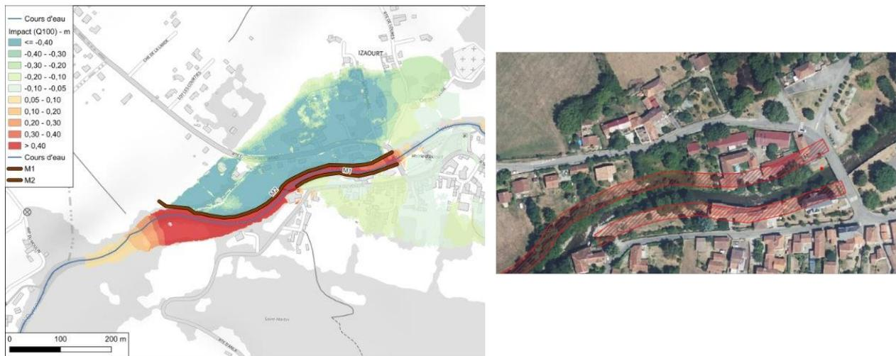
Figure 44: Zone inondable d'une crue centennale à l'état de référence comparé à l'état aménagé avec l'endiguement des deux rives (carte à gauche) – Emprise foncière des digues (carte à droite)
