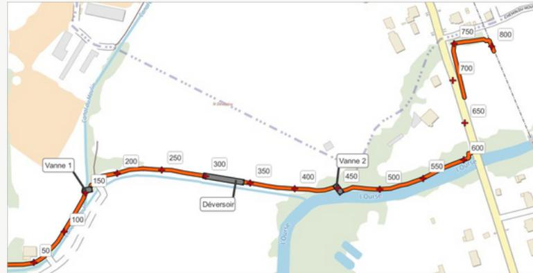
Figure 2 : Projet de système de protection projeté (en orange les digues, en gris les vannes et le déversoir)
